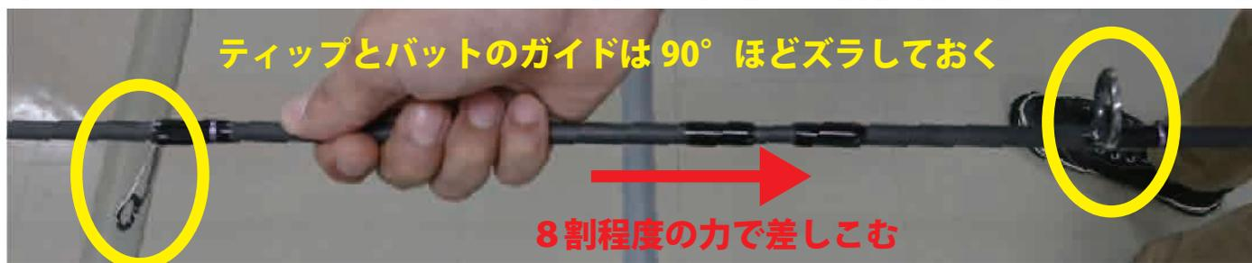
②バットとティップのブランクスを握り、横回転をさせながら差しこみます。ねじり込むようなイメージです。こうすることで横方向の摩擦が発生し、抜けにくくなります。
